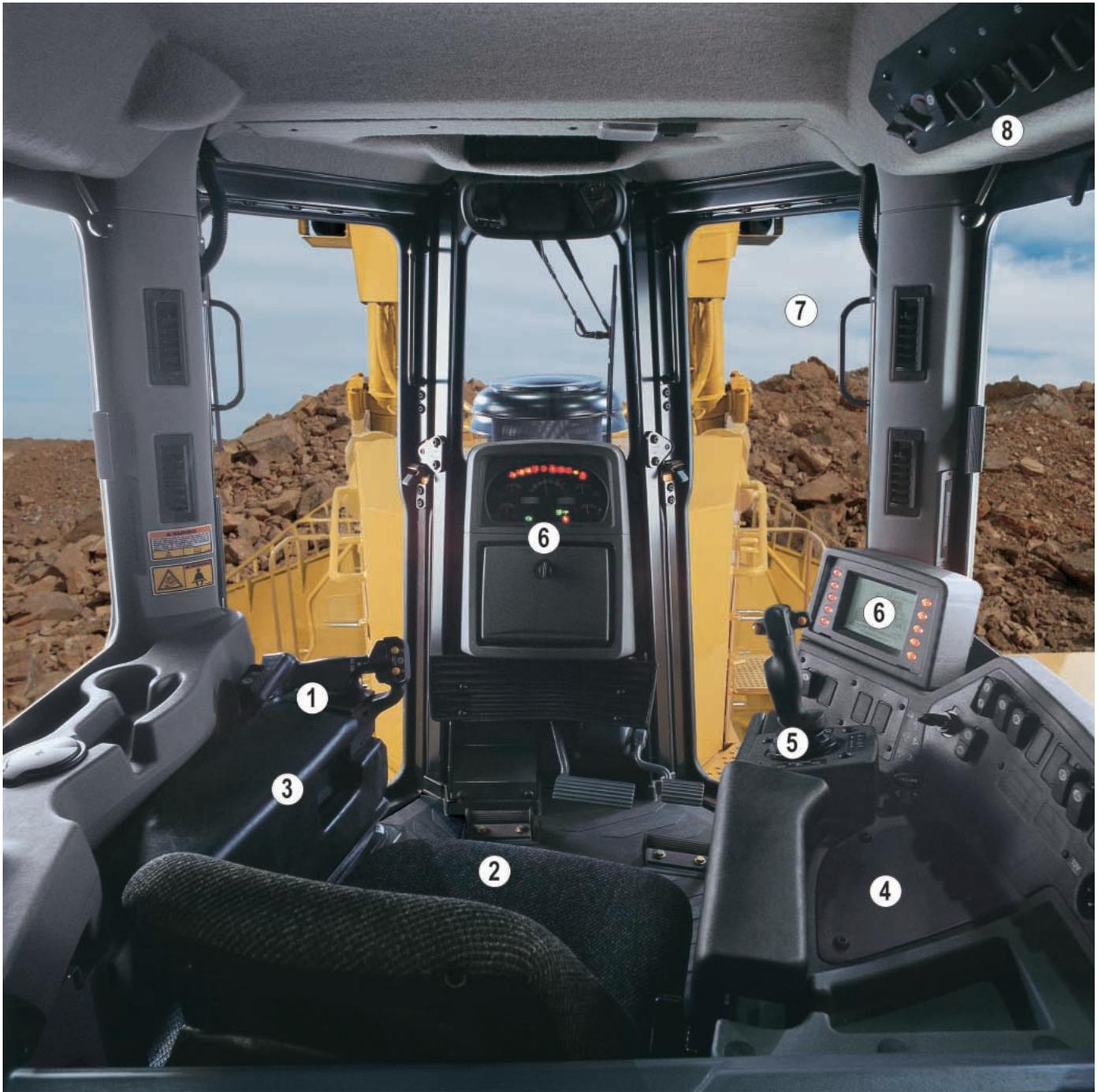
**1) Control de la dirección.** El Control en la Punta de los Dedos (FTC) combina la dirección, el sentido de desplazamiento de la máquina y la selección de marchas en un sistema de control operado con una mano para aumentar la comodidad y la productividad del operador.
