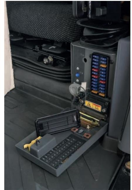
**Tablero de fusibles y acceso al sistema de diagnóstico.** El nuevo compartimiento tiene un tablero de fusibles en una sola ubicación que incluye un puerto de diagnóstico para que Cat ET se conecte con el fin de proporcionar diagnósticos rápidos de la máquina.
