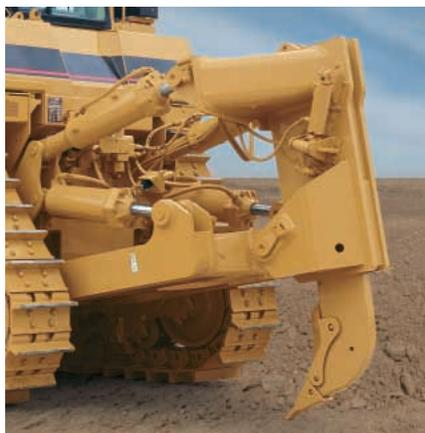
**Desgarrador con un vástago.** El operador puede ajustar la profundidad del vástago desde el asiento mediante un extractor de pasador de un vástago optativo. El orificio de visión grande del bastidor superior aumenta la visibilidad de la punta del desgarrador. Las barras espaciadores termotratadas en el portador del desgarrador prolongan la duración de las cavidades y reducen las muescas del vástago. Se dispone de un vástago de una pieza en la configuración para desgarramiento profundo.
