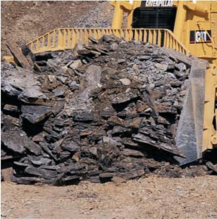
**Hojas topadoras.** Todas las hojas tienen un diseño fuerte de sección en caja que resiste los movimientos de torsión y agrietamiento. Las hojas están hechas de acero DH-2™ Cat con alta resistencia a la tracción que resiste las aplicaciones más rigurosas. Vertedera de construcción pesada y cuchillas y cantoneras endurecidas empernadas que confieren resistencia y durabilidad.
