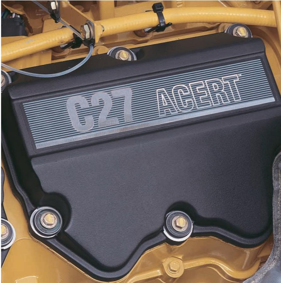
**Motor C27.** Al funcionar a la máxima potencia neta nominal de 433 kW (580 hp) a 1.800 rpm con una alta reserva de par del 21 por ciento, la gran cilindrada y la elevada reserva de par permiten al D10T explanar materiales difíciles. En combinación con el divisor de par de alta eficiencia y la servotransmisión de control electrónico, proporcionará muchos años de servicio fiable.
