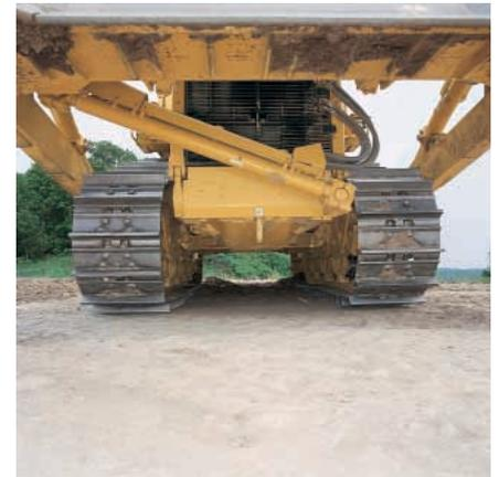
**Tirante estabilizador.** El tirante estabilizador acerca más la hoja a la máquina para obtener un control más preciso de explanación y carga.
