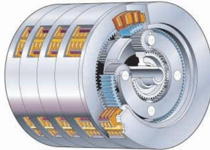
**Divisor de par.** El convertidor de par de una sola etapa con divisor de par de salida envía el 75% del par motor por el convertidor y el 25% por un eje de mando directo para obtener una mayor eficiencia del sistema de mando y una mayor multiplicación de par. El convertidor de par protege la línea de mando contra los impactos de torsión súbitos y las vibraciones.
